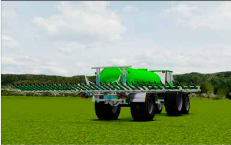
Der Speedy One kann einfach und schnell an neue und gebrauchte Güllefässer mit Schleppschuhvorbereitung montiert werden. Die neue vollautomatische Steuerung für diesen Verteiler erfordert nur ein doppelt wirkendes Steuergerät am Schlepper. Alle Funktionen wie Ein- und Ausklappen, Heben und Senken, Antrieb der Schneidverteilköpfe und der Schieber / Dreiwegehahn werden automatisch in Folge geschaltet.
